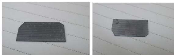
شکل ۳. ویفر سیلیکونی سمت راست آلییده با بور و ویفر سیلیکونی سمت چپ آلییده با فسفر است
