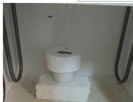
شکل ۲. الف) نحوه قرارگیری ویفرهای سیلیکونی در کوره اتمسفر کنترل استوانه‌ای و آلیش آن‌ها با بور و فسفر (ب) نمایی از داخل کوره برای آلیش سیلیکون
