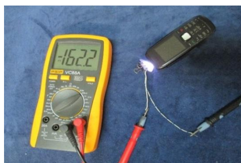
شکل ۱۱. ولتاژ تولیدی حاصل از نمونه آزمایشگاهی دیود p-i-n ساخته شده
