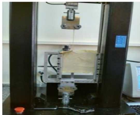
شکل ۲. آزمون بیرون کشی الیاف
