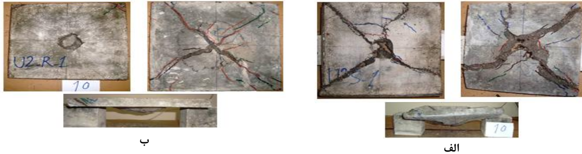
شکل ۹. الگوی گسیختگی نهایی؛ (الف) پانل U-S و (ب) پانل U-R؛ (راست) وجه پشتی و (چپ) وجه جلویی
