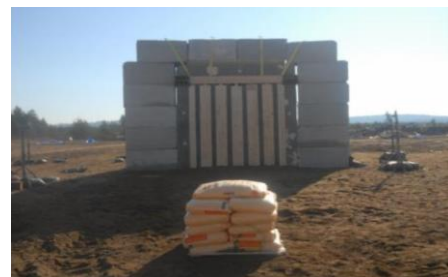
شکل ۸. نمای جلو از مدل آزمایشگاهی انفجار [۱۸]
